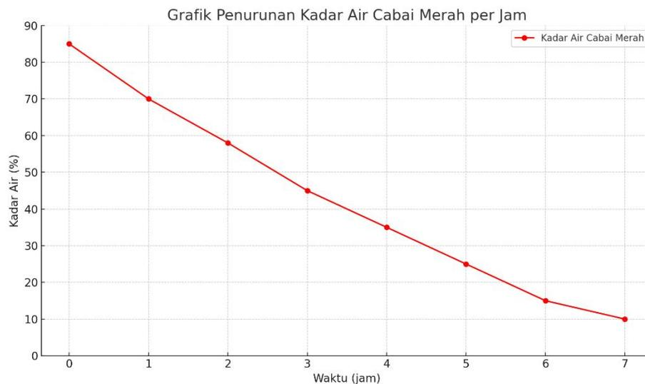
Grafik ini menunjukkan tren penurunan kadar air yang signifikan dari 85% menjadi sekitar 10% dalam waktu 7 jam proses pengeringan menggunakan alat pengering tenaga surya bertingkat.
